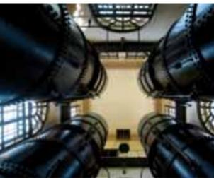
Das am Hochablass ausgestaute Wassertrieb seit 1879 die Turbinen im Wasserwerk am Hochablass an, die über die Königswelle die mächtigen Plungerpumpen in Bewegung brachten. Die drei Pumpensätze und die mächtigen, rund zehn Meter hohen Druckwindkessel sind imponierende Technikdenkmäler. Auf den Besucher wirken diese Zeugnisse des frühen Industriealters wie Dinosaurier – Relikte einer seit Langem vergangenen Epoche. Doch dieses Wasserwerk war bis 1973 in Betrieb.
